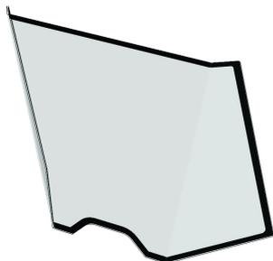
Panneau Hammerglass pour remplacer la vitre d'origine. Avec film protecteur ScreenSaver appliqué d'usine. A coller comme le pare-brise d'origine. **IMPORTANT!** Utiliser de la colle élastique! NE utilisez pas de colle normale pour le verre automobile. Le film peut être remplacé lorsqu'il est endommagé ou rayé.
