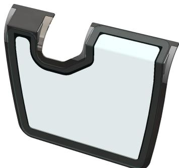
Panneau Hammerglass IR Green dans cadre acier pour remplacer la vitre d'origine. Hammerglass IR absorbera le rayonnement infrarouge du soleil et réduira la chaleur solaire entrante de 50%. A coller comme le pare-brise d'origine. **IMPORTANT!** Utiliser de la colle élastique! NE utilisez pas de colle normale pour le verre automobile.
