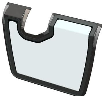
Panneau Hammerglass IR Green dans cadre acier pour remplacer la vitre d'origine. Avec film protecteur ScreenSaver appliqué d'usine. Hammerglass IR absorbera le rayonnement infrarouge du soleil et réduira la chaleur solaire entrante de 50%. A coller comme le pare-brise d'origine. **IMPORTANT!** Utiliser de la colle élastique! NE utilisez pas de colle normale pour le verre automobile. Le film peut être remplacé lorsqu'il est endommagé ou rayé.
