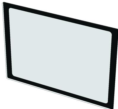
Panneau Hammerglass IR Green pour remplacer la vitre d'origine. Hammerglass IR absorbera le rayonnement infrarouge du soleil et réduira la chaleur solaire entrante de 50%. A coller comme le pare-brise d'origine. **IMPORTANT!** Utiliser de la colle élastique! NE utilisez pas de colle normale pour le verre automobile.
