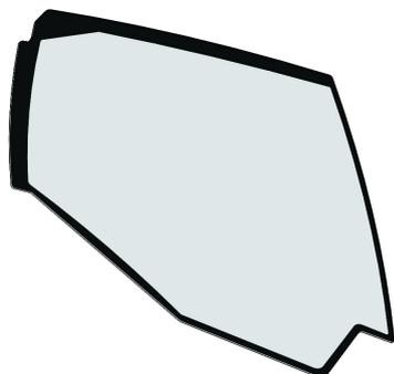
Panneau Hammerglass pour remplacer la vitre d'origine. A coller comme le pare-brise d'origine. **IMPORTANT!** Utiliser de la colle élastique! NE utilisez pas de colle normale pour le verre automobile.
