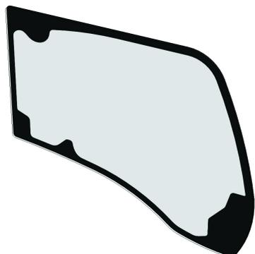
Panneau Hammerglass IR Green pour remplacer la vitre d'origine. Hammerglass IR absorbera le rayonnement infrarouge du soleil et réduira la chaleur solaire entrante de 50%. A coller comme le pare-brise d'origine. **IMPORTANT!** Utiliser de la colle élastique! NE utilisez pas de colle normale pour le verre automobile.
